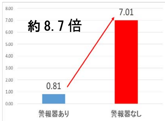
図3 平成28年の市内住宅1万戸当たりの出火率と住宅火災警報器の効果(火災件数/住宅1万戸)
