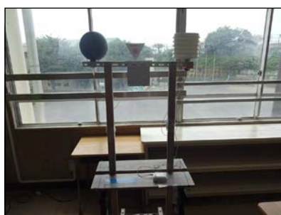
図2 教室内での温度・黒球温度の測定
